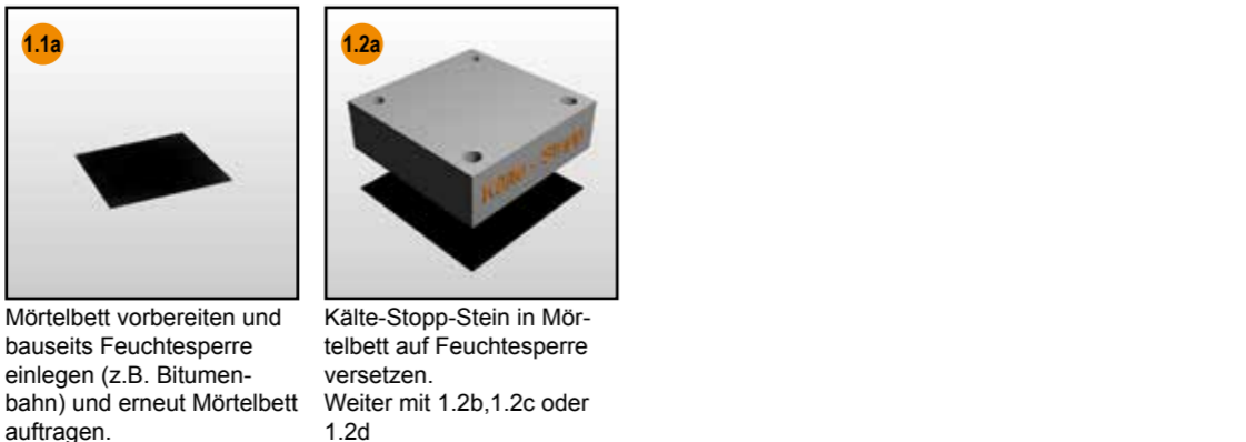
1.1b Mörtelbett vorbereiten und bauseits Feuchtesperre einlegen (z.B. Bitumenbahn) und erneut Mörtelbett auftragen. 1.2b Sockelstein in Mörtelbett auf Feuchtesperre versetzen. weiter mit 1.2c oder 1.2d
